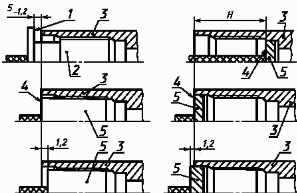
1 — измерительная плоскость резьбового калибра-пробки; 2 — резьбовой калибр-пробка; 3 — раструбный конец трубы; 4 — измерительная плоскость гладкого калибра-пробки; 5 — гладкий калибр-пробка
