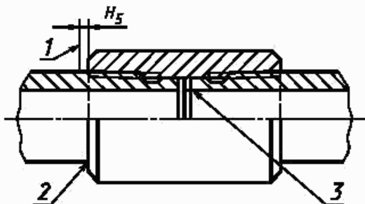
1 — конец свеча резьбы; 2 — соединение, свинченное вручную; 3 — соединение, свинченное на станке
