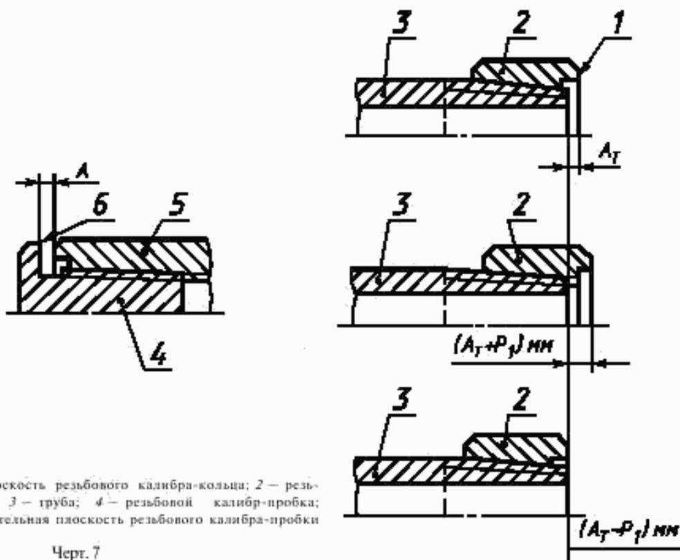
1 — измерительная плоскость резьбового калибра-кольца; 2 — резьбовой калибр-кольцо; 3 — труба; 4 — резьбовой калибр-пробка; 5 — муфта; 6 — измерительная плоскость резьбового калибра-пробки
