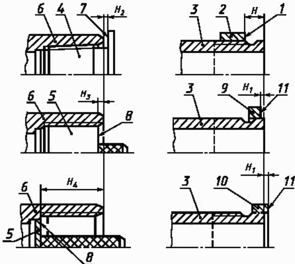
1 — измерительная плоскость резьбового и гладкого калибров-колен; 2 — резьбовой и гладкий калибры-кольца; 3 — труба; 4 — резьбовой калибр-пробка; 5 — гладкий калибр-пробка; 6 — муфта; 7 — измерительная плоскость резьбового калибра-пробки; 8 — измерительная плоскость гладкого калибра-пробки; 9 — гладкий калибр-кольцо для проверки труб условным диаметром от 60 до 102 мм; 10 — гладкий калибр-кольцо для проверки труб условным диаметром 114 мм; 11 — измерительная плоскость гладкого калибра-кольца
