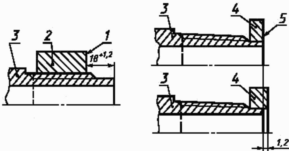
1 — измерительная плоскость резьбовых (с полным и неполным профилем) и гладкого калибров-колец; 2 — резьбовой (с полным и неполным профилем) и гладкий калибра-кольца; 3 — концевой конец трубы; 4 — гладкий калибра-кольца; 5 — измерительная плоскость гладкого калибра-кольца
